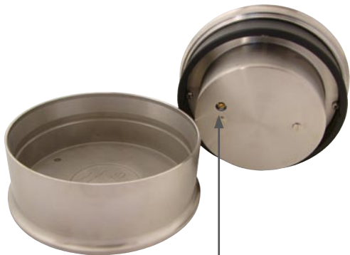
Justérskruen til kalibrering af barometeret.
